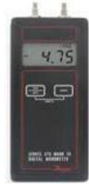
Figure 6 : Capteur de pression utilisé pour mesurer la pression aux bouches
