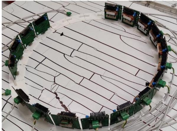
Figure 26 : Exemple de la disposition des capteurs pour l'étalonnage en humidité
