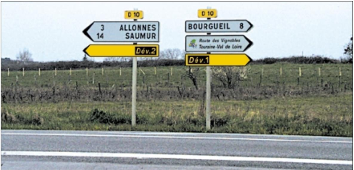
Exemple d'utilisation des panneaux KD 22 avec la numérotation des déviations.
