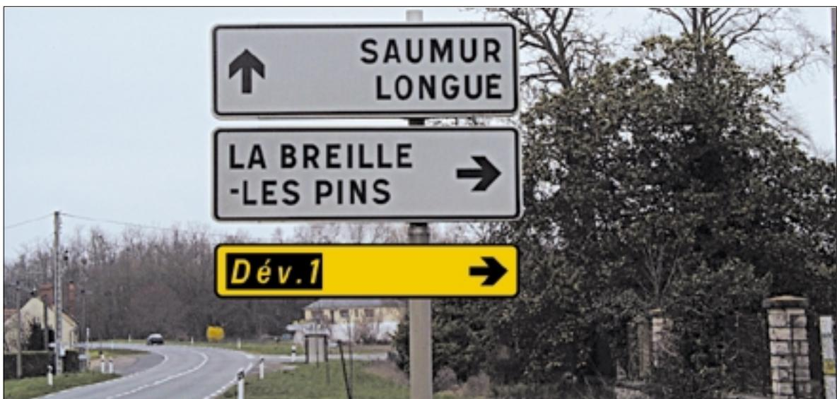
Exemple d'utilisation des panneaux KD 43 avec la numérotation des déviations.
