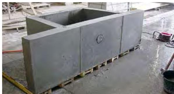
Photos 6 : panneaux et mini voussoir d'essai – Source : CETE de Lyon
