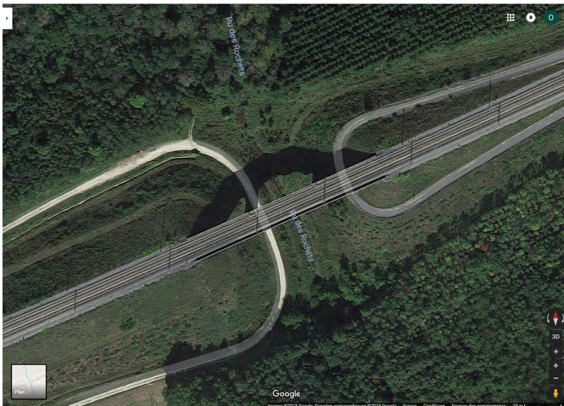
Figure 19 : Présence d'un passage à faune spécifique inférieur sur la ligne du TGV Est sur la commune d'Essomes-sur-Marne (02) (source Images ©2018 Google, Données cartographiques ©2018 Google).
