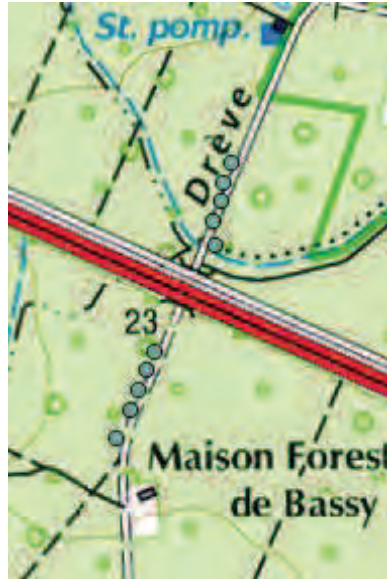
Figure 37 : Localisation des plaques à reptiles : 5 au sud et 5 au nord du passage inférieur espacés de 25 m environ
