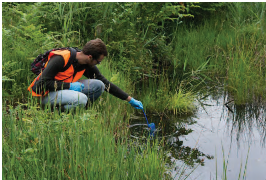
Figure 31 : Processus de prélèvement d'eau pour l'analyse ADN environnemental (ADNe) Photo cc-by-sa O. Pichard
