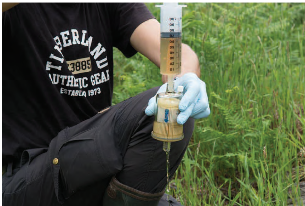
Figure 32 : Filtration de l'eau prélevée et fixation de l'ADN sur une membrane contenue dans une capsule. Photo cc-by-sa M. Gilleron
