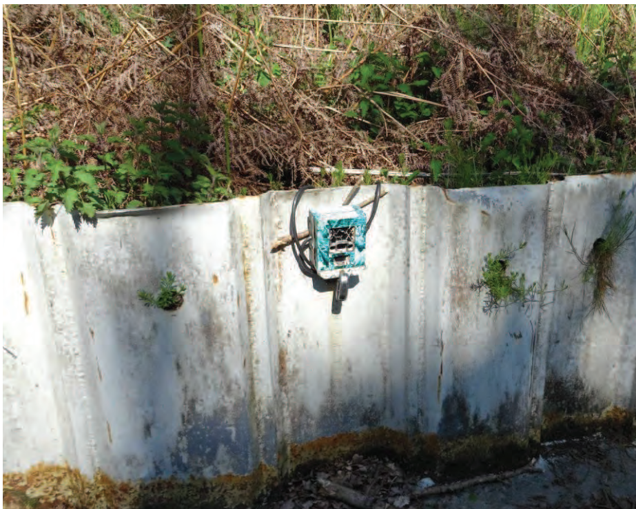
Figure 15 : Piège photographique installé contre une palplanche avec un cadenas en bas du boîtier de protection et un câble antivol, le boîtier est placé à 1,20 m de hauteur environ et légèrement incliné vers le bas
