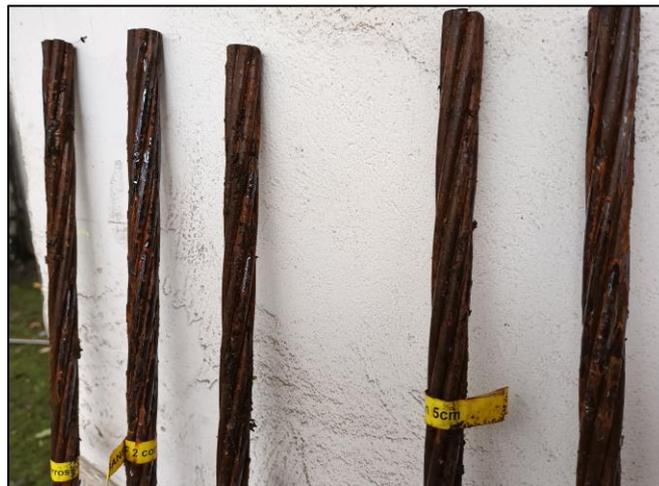
Figure 14 - Echantillons de torons corrodés.
