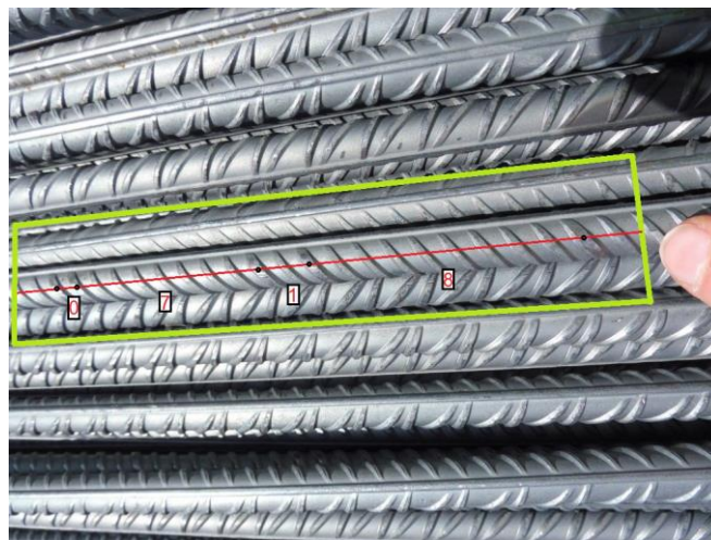
Figure n°4 : Vue d'aciers pour béton armé avec marque de laminage (signature) sur l'un d'entre eux.
