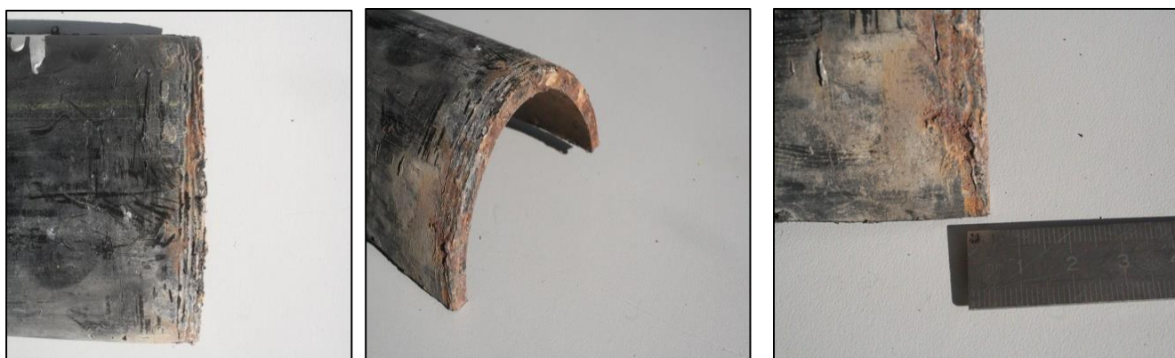
Figure n°18 : Observations des soudage/collage de l'extrémité du conduit
