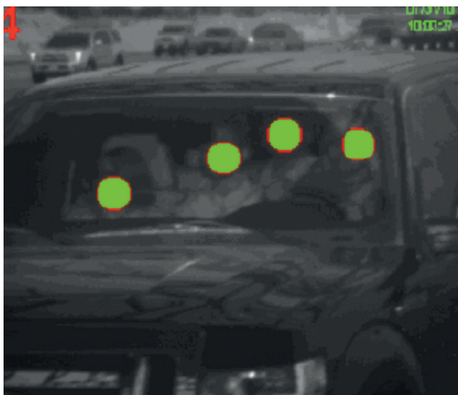
Mesure automatique du nombre d'occupants d'un véhicule. Source : University of California PATH (Partners for Advanced Transportation Technology)
