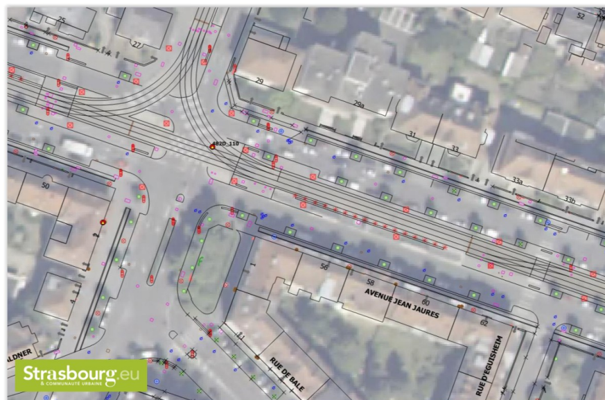
Représentation au 1/500ème d'éléments constitutifs du PCRS établis à partir de données de la Communauté Urbaine de Strasbourg (fond de plan ©IGN - BDORTHO)
