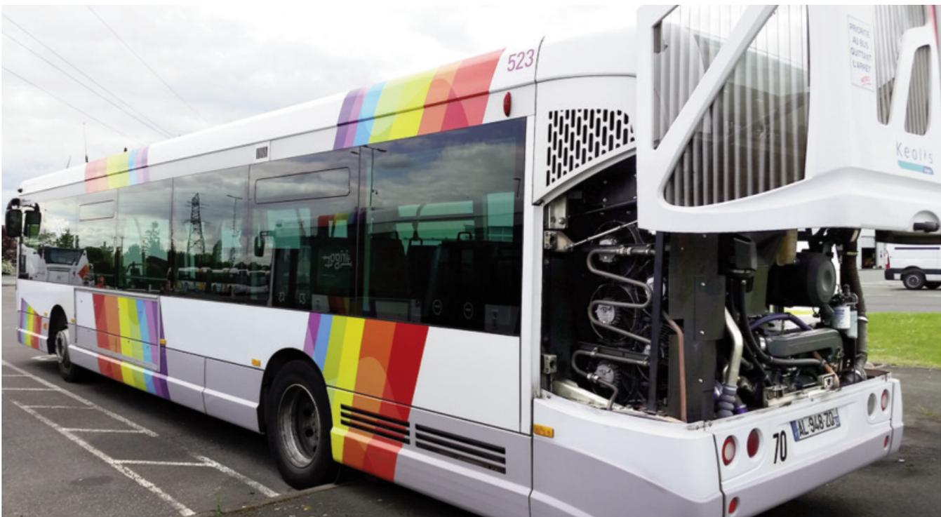
Mise en œuvre du système e-Fan visible à l'arrière d'un bus du réseau d'Angers Loire Métropole
