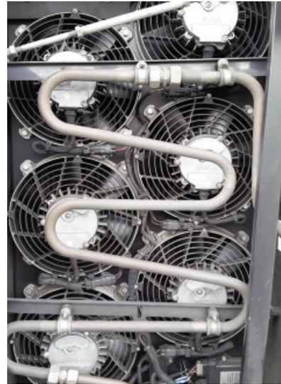
Le système e-Fan qui remplace l'équipement de ventilation hydraulique des moteurs par des microventilateurs électriques a été développé par la société AVID Technology Ltd, basée en Grande-Bretagne. Il a été testé à Angers sur 6 bus.
