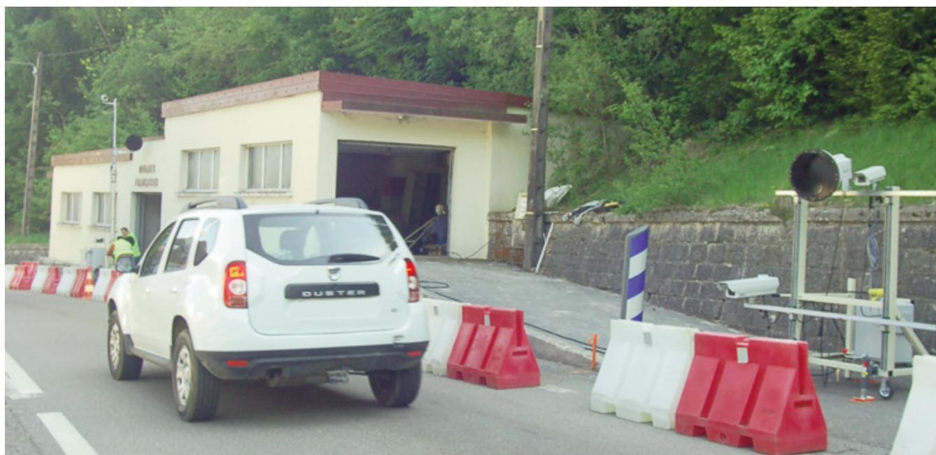
Le dispositif, constitué de deux appareils photos fonctionnant dans l'infrarouge, permet de compter automatiquement le nombre de passagers par véhicule
