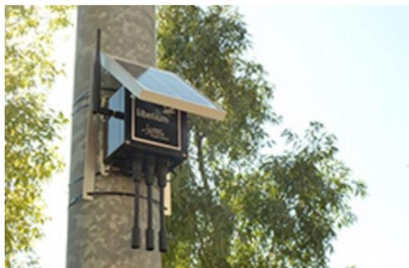
Photo d'un capteur de qualité de l'air (particules fines, O<sub>3</sub>, NO<sub>2</sub>) - Site du constructeur : Libelium <http://www.libelium.com> (source : étude Cerema)
