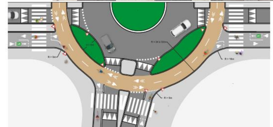
Précision de traitement d'une intersection régulée par feux dans le cas d'un croisement de pistes bidirectionnelles
