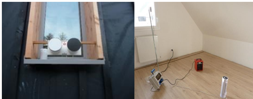
Figure 5 : kit de mesure Diane/Sereine : capteur façade (gauche) - module intérieur (droite)
