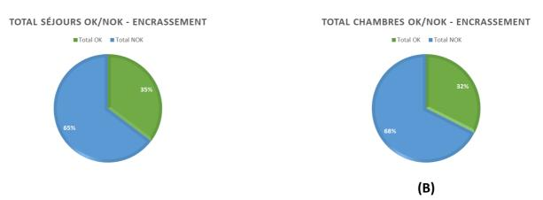
Figure 10 : A) Représentation de l'état des entrées d'air des séjours (Total : 17). B) Représentation de l'état des entrées d'air des chambres (Total : 37)
