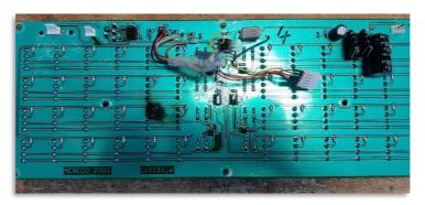
Figure 27 : Dysfonctionnement d'un multiplexe à cause d'un court-circuit
