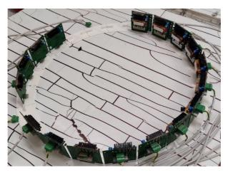
Figure 26 : Exemple de la disposition des capteurs pour l'étalonnage en humidité
