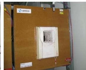
Figure 4 : Bouche d'extraction installée sur le banc Aereco
