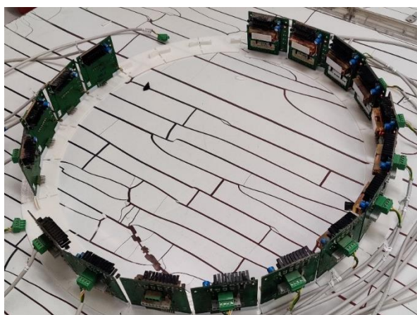
Figure 12 : Exemple de la disposition des capteurs pour l'étalonnage en humidité
