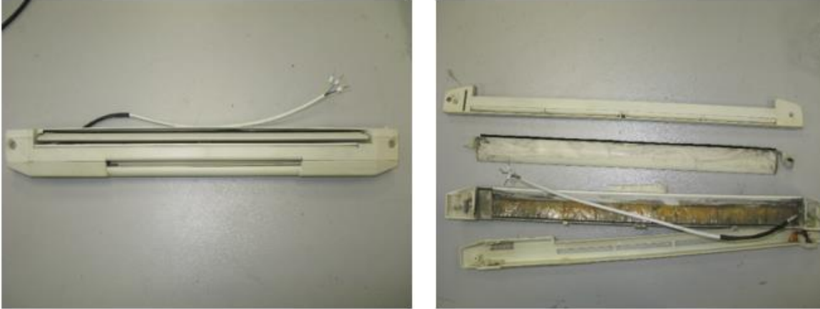
Figure 15 : Exemple d'une entrée d'air instrumentée (assemblée à gauche et démontée à droite)
