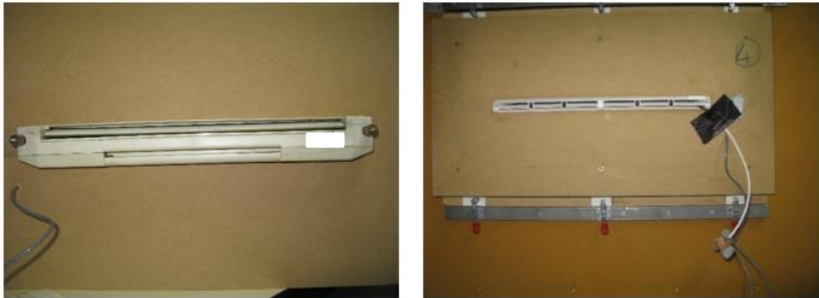
Figure 16 : exemple d'entrée d'air montée sur le banc de mesure
