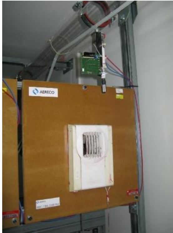
Figure 10 : Bouche cuisine montée sur le banc de mesure
