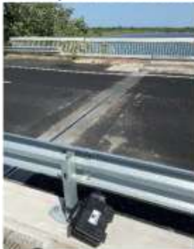
Enregistrement du bruit de passage de véhicules sur des joints de chaussées
