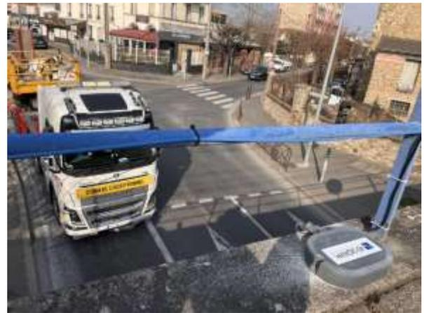
Fig. 4 : capteur « Probe 2 » de l'Ad-Signum installé sur un PRA
