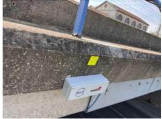
Fig. 2 : capteur autonome VeRi
