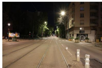
\*Pour cette étude, la luminance considérée est moyennée sur les luminances mesurées sur la plateforme entre les deux rails, entre 30m et 60m en amont du tramway
