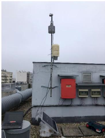
Les capteurs NEMo sont des capteurs portables qui mesurent en continu les paramètres QAI avec un pas d'enregistrement toutes les 10 min → suivi en temps réel qui va permettre de diagnostiquer la qualité de l'air à des concentrations de l'ordre du  $\mu\text{g}/\text{m}^3$
