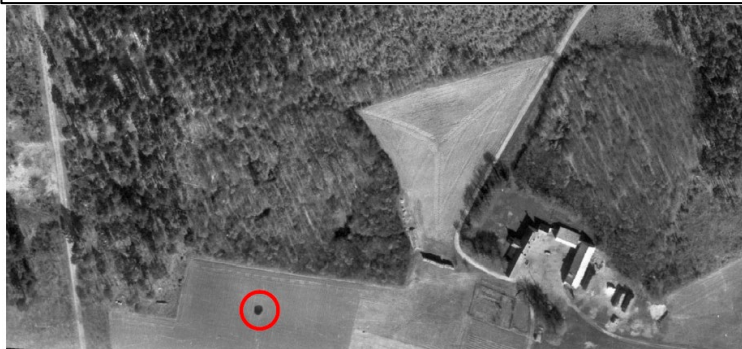
1961 - Effondrement à la ferme des Vallées : diamètre \approx 7.5 m.
