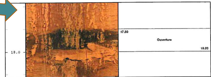
Figure 4 : Profonde ouverture dans le SD2
