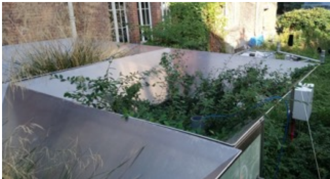
4 surfaces de ruissellement pour une surface d'infiltration = Ratio de 4
