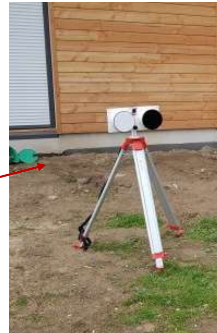
Capteur SENS façade Sud-Ouest sur trépied dans le jardin
