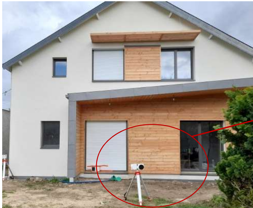
Capteur SENS façade Sud-Ouest sur trépied dans le jardin
