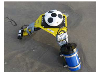
Courantomètre profileur AWAC
