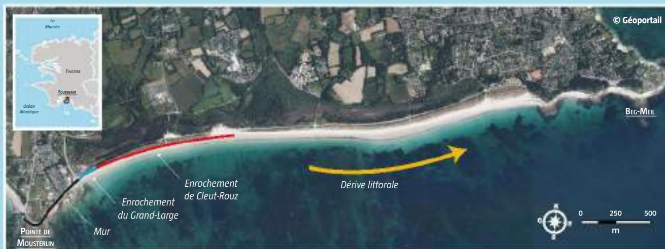
Figure 25 : positions des ouvrages littoraux et sens de la dérive littorale dominante entre les sites de Moustierlin et Beg-Meil à Fouesnant.
