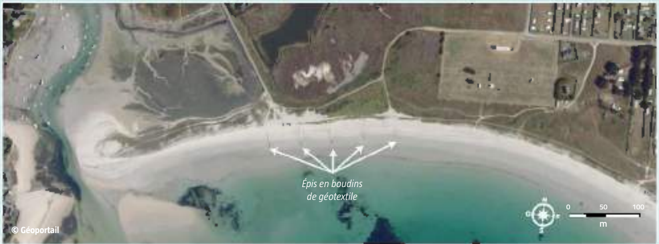
Figure 59 : la plage des Sables Blancs à Plobannaec-Lesconil en décembre 2005 et position des 5 ouvrages transversaux en géotextiles.
