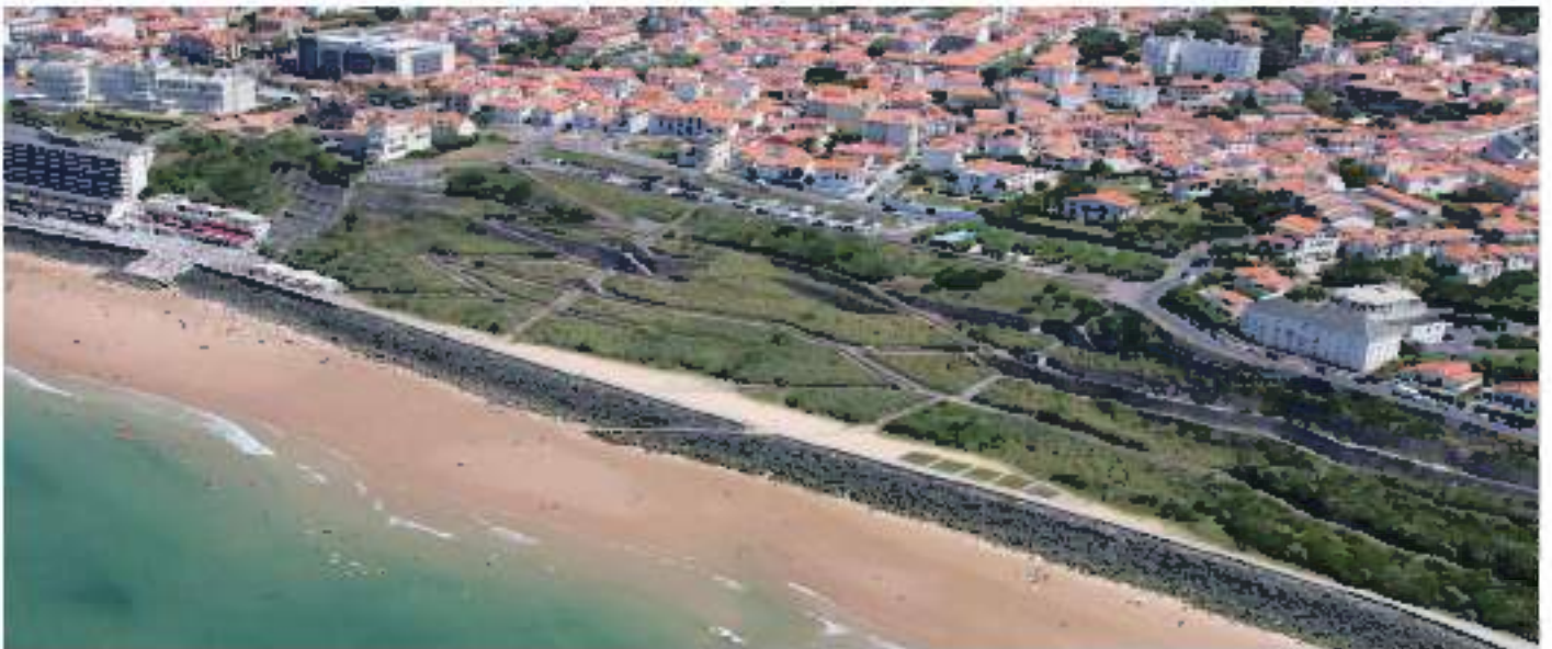
Figure 96 : reprofilage de falaise sur la côte des Basques de Biarritz (64). (d'après l'Observatoire de la côte de Nouvelle-Aquitaine, 2020)
