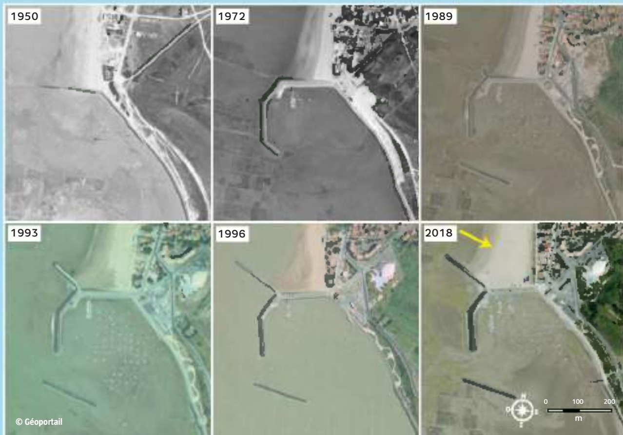
Figure 122 : au sud de la plage de Châtelailillon, évolution de l'épi de l'Eperon et du littoral entre 1950 et 2018. La flèche jaune souligne l'accumulation sédimentaire créée par la jetée-épi.
