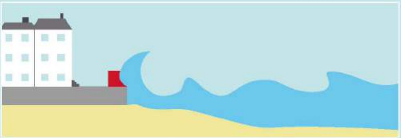
Figure 157 : digue amovible composée de déflecteurs incurvés lestés à des sacs de sable
