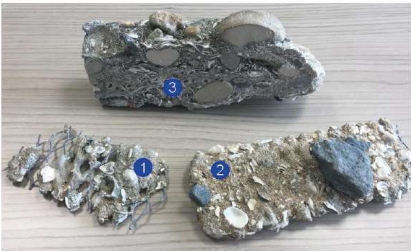
Figure 172 : évolution de la formation du matériau : 1) au bout de trois semaines ; 2) au bout de deux mois et 3) au bout d'un an. (d'après Perrier, 2019)
