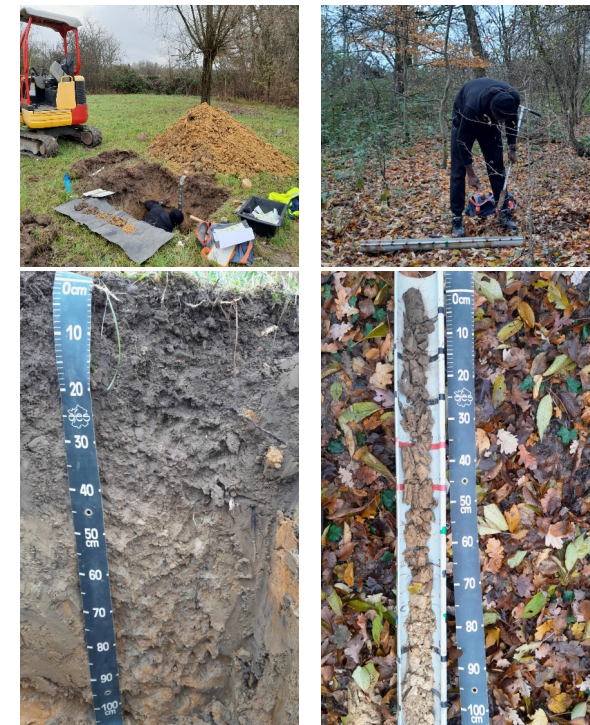
Observations en fosse (à gauche) et en sondage (à droite)
