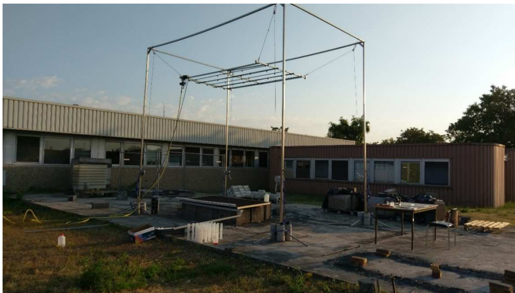
Photo 1 – Dispositif expérimental d'évaluation en conditions contrôlées de l'impact environnemental de l'épandage de lait de chaux (plaque d'essai positionnée sous le portique du système de génération de pluie artificielle)
