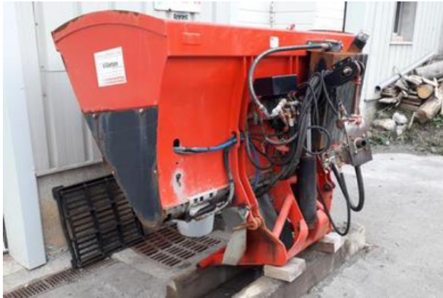
Figure 6: Exemple de matériel communal et de sel resté dans la vis d'extraction. La couleur bleue observée est caractéristique de la réaction entre l'anti-mottant du sel et le fer ferrique qui laisse suggérer l'oxydation des pièces en acier.
