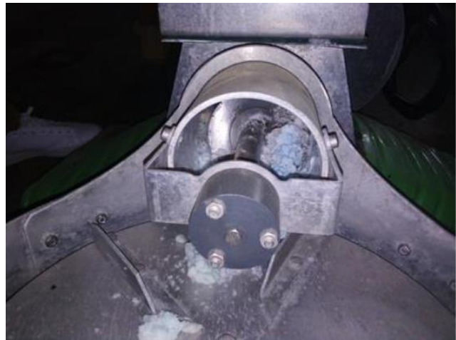
Figure 6: Exemple de matériel communal et de sel resté dans la vis d'extraction. La couleur bleue observée est caractéristique de la réaction entre l'anti-mottant du sel et le fer ferrique qui laisse suggérer l'oxydation des pièces en acier.
