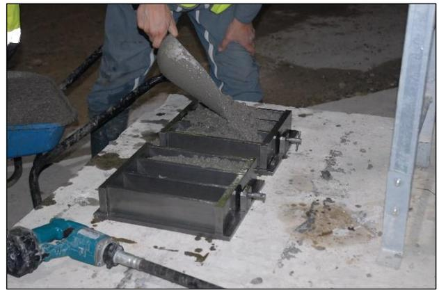
Figure n°50 : Coulage d'éprouvettes 7 x 7 x 28 cm.
