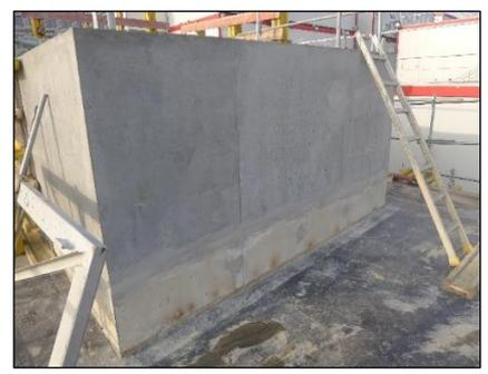
Figure n°34 : Plot d'essai pour tester le bon positionnement des puits.
