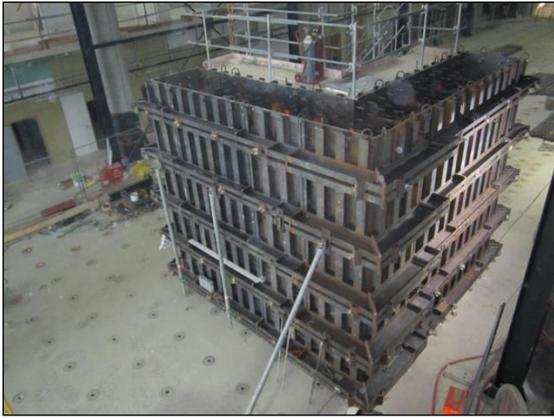
Figure n°62 : Fermeture du coffrage des murs
