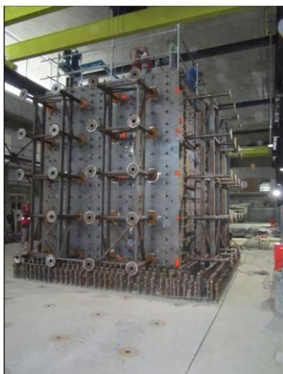
Figure n°58 : Installation de la peau métallique avec ses connecteurs, et les puits d'ancrage des murs de réaction.
