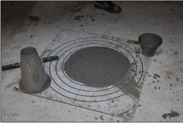
Figure n°47 : Etalement de 500 mm.
