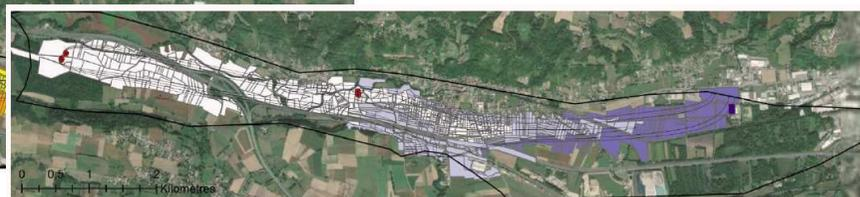
Figure 8 - Cartographie des temps de transits des eaux souterraines via la zone saturée de la nappe jusqu'aux captages du secteur Cassieu-Vernay. Les localisations des forages sont représentées par des points rouges. La limite du domaine modélisé est représentée par une ligne noire.
