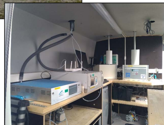
Intérieur du moyen mobile avec différents analyseurs
