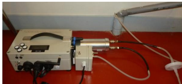
Mesure dynamique avec le Radon mapper - Cerema
