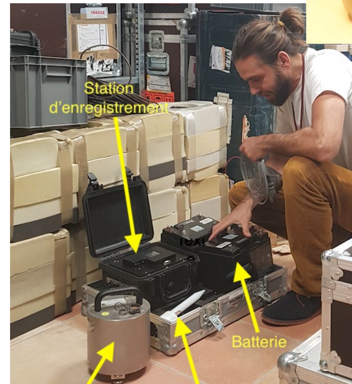
Haut : Numériseurs DM24 Guralp et Kephren (Recodages) Droite : Vélocimètres Le3D Lite (1s) et Guralp CMG40T (5s)
