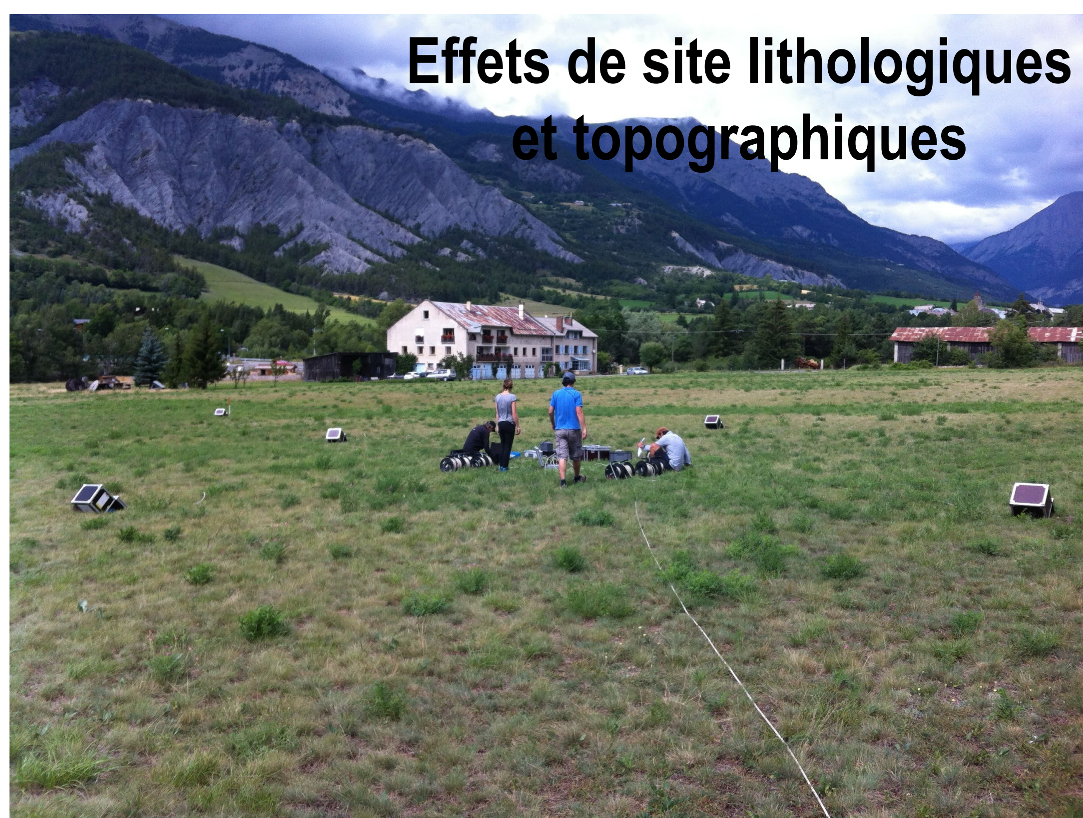
Campagne de bruit de fond « réseau » pour imager la structure du sous-sol d'une vallée alpine. Vallée de l'Ubaye (04)
