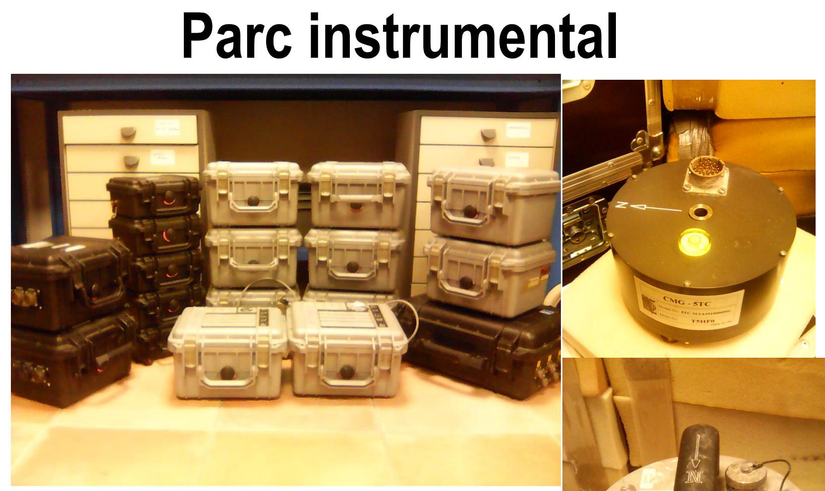
Haut : Numériseurs DM24 Guralp et Kephren (Recodages) Droite : Vélocimètres Le3D Lite (1s) et Guralp CMG40T (5s)
