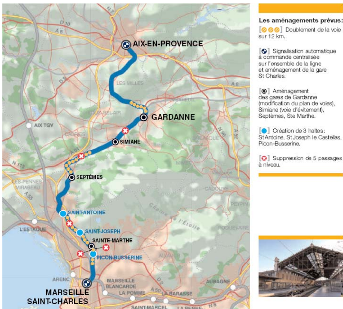
Figure 2 - Projet de modernisation de la ligne Aix-Marseille – Source : document de communication de RFF autour des travaux de modernisation de la ligne ferroviaire Aix-en-Provence Gardanne Marseille
