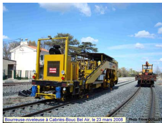
Figure 4 - Bourreuse niveleuse (source : FNAUT Pays des Maures)
