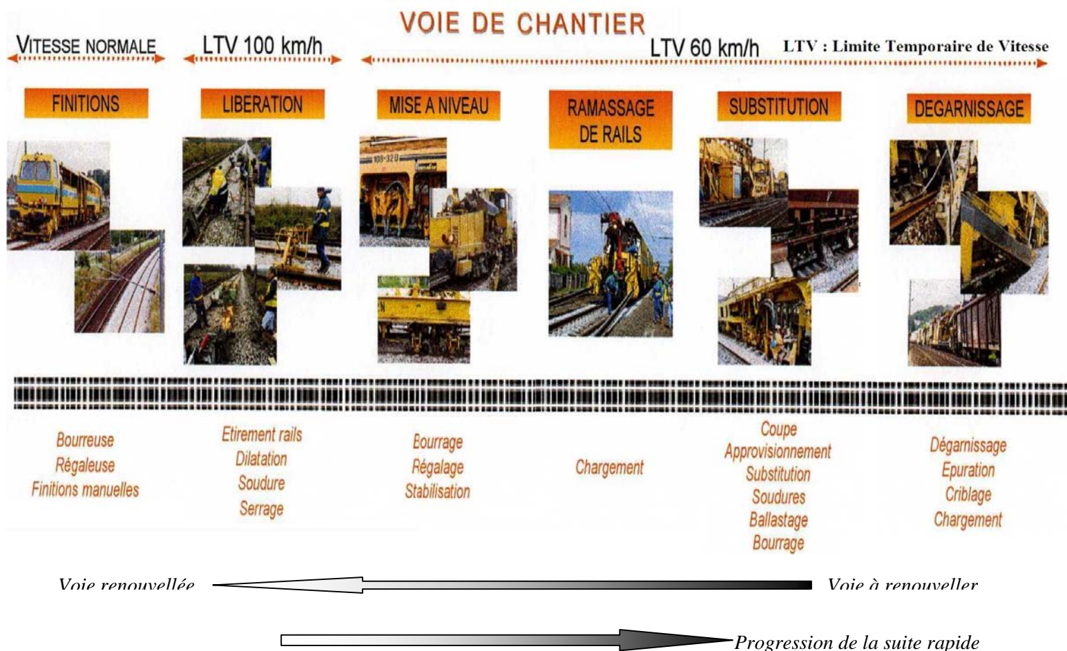
Figure 3 - Opérations réalisées lors du passage de la suite rapide (Source : RFF)
