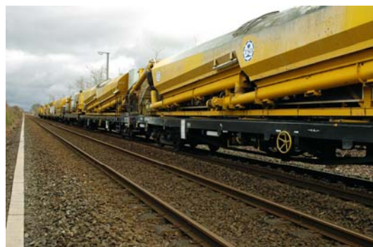
Train de béton
