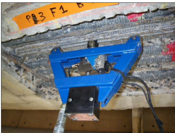
Figure n°5 : Mesure de la précontrainte résiduelle à l'arbalète
