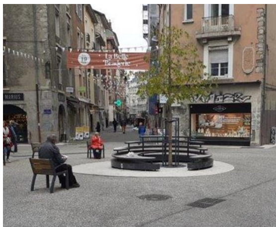
Figure 23 : Les zones d'agrément sont cerclées par un matériau clair au sol, et contrasté. La zone d'assises est détectable à la canne. Le cheminement usuel est en béton désactivé gris. (source : Grenoble Alpes Métropole)
