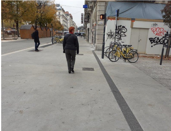
Figure 16 : La continuité piétonne sur les trottoirs est assurée aux intersections avec les rues de desserte locale avec une bande de guidage au sol, en résine, contrastée (source : Grenoble Alpes Métropole)
