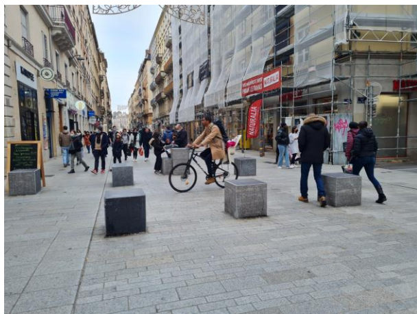
Figures 7 et 8 : La traversée perpendiculaire de l'aire piétonne par des véhicules est matérialisée par la présence de bornes en béton qui servent également dans la lutte contre les attentats, tout en permettant l'accès des pompiers. Ces plots massifs sont à la fois des repères et des obstacles. Le contraste a été créé par une face peinte en noir (source : Métropole de Lyon)
