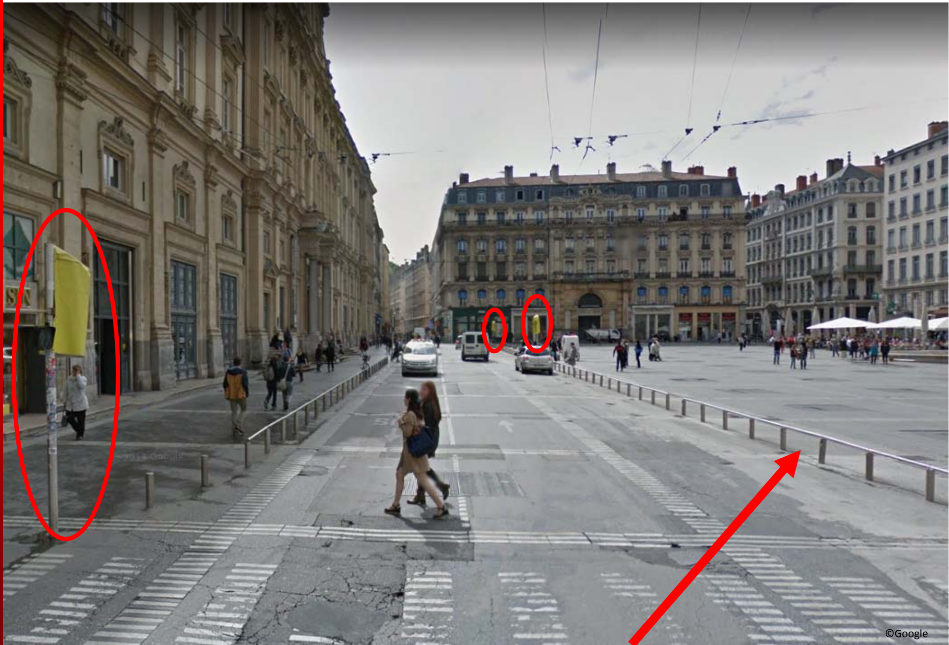
Barrières continues canalisant les piétons
