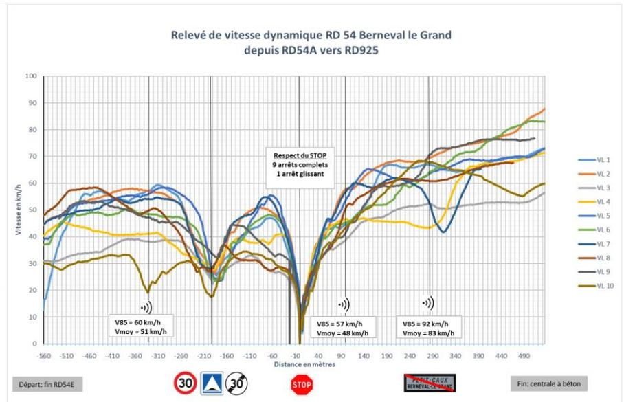
Nota : les courbes représentent les profils de vitesse des usagers relevés par le véhicule instrumenté ; les Vmoy et V85 sont issues des mesures « bord de voie ». L'écart observé relève du fait que certains usagers n'ont pas pu être suivis du fait d'une vitesse excessive.
