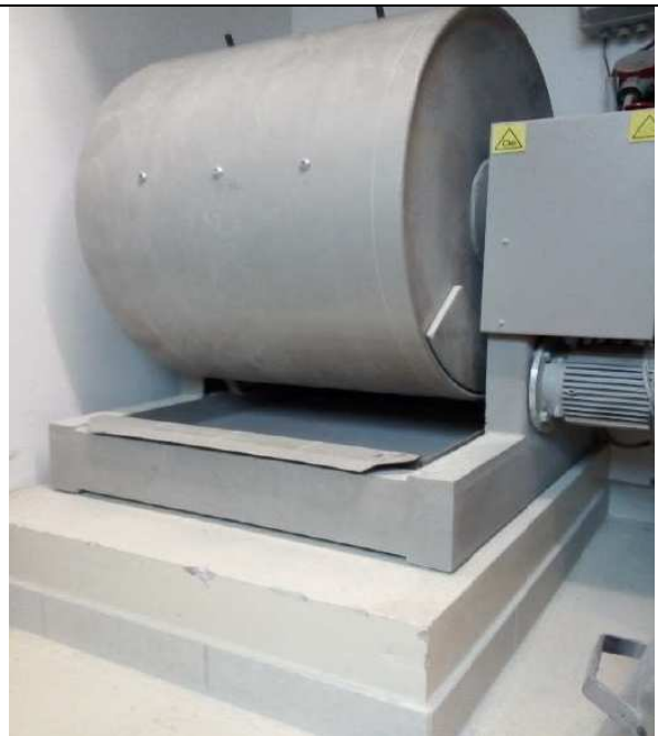
LA = 22,0 Type CONTROLS Directement sur béton
