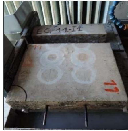
Figure n°11 : Tronçonnage d'une dalle pour le prélèvement des armatures
