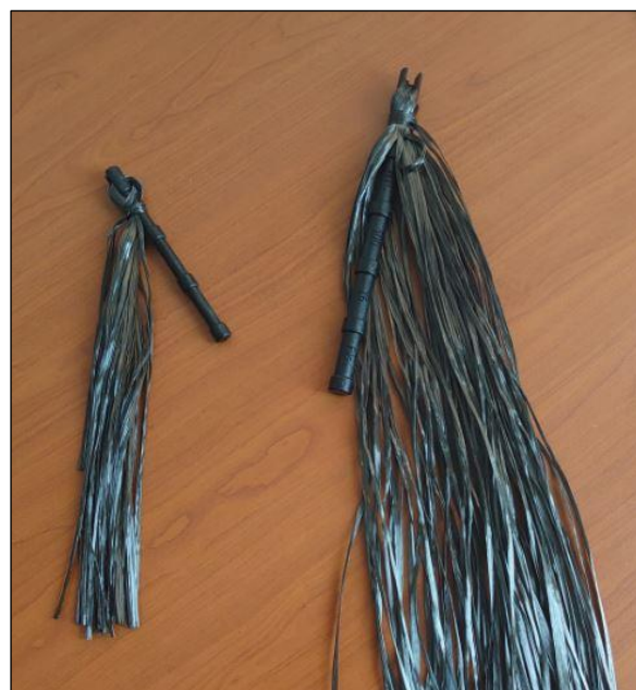
Figure n°29 : Mèches en carbone
