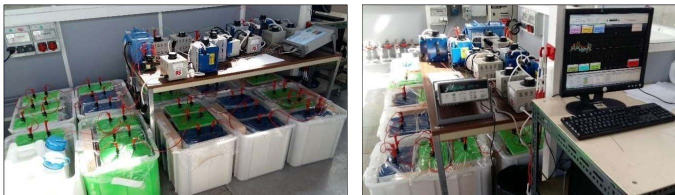
Figure n°9 : Montage expérimental A gauche, vue d'ensemble. A droite, centrale d'acquisition et écran de contrôle des tensions et courants
