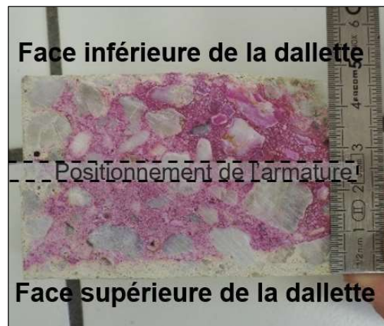
Figure n°13 : Vérification de l'absence de carbonatation du béton au cœur de la dalle
