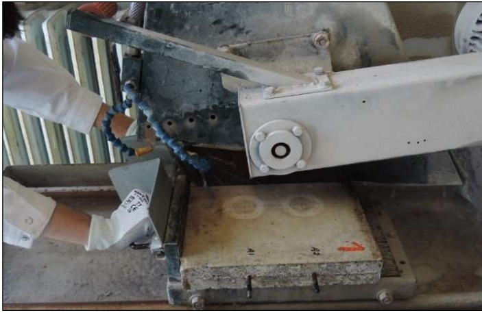
Figure n°11 : Tronçonnage d'une dalle pour le prélèvement des armatures
