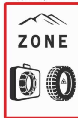
Panneau B58: Entrée de zone d'obligation d'équipements en période hivernale
