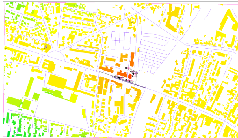
Niveaux sonores en façade riverains
