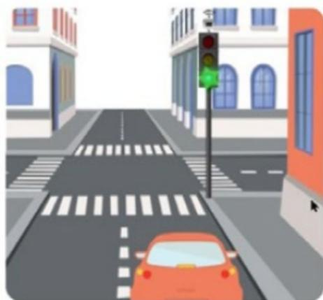
Le capteur détecte l'arrivée d'un véhicule: **LE FEU PASSE AU VERT**, car il n'y a aucun autre usager à l'intersection (véhicule ou piéton).
