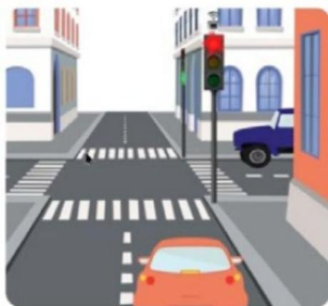
Le capteur détecte l'arrivée d'un véhicule: **LE FEU NE PASSE PAS AU VERT**, car un autre usager (véhicule ou piéton) est arrivé en premier à l'intersection.
