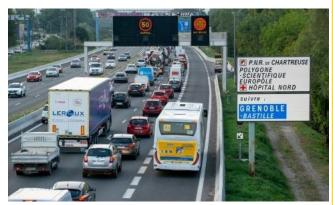
5 km sur l'espace de la BAU Activée en cas de congestion Réservée aux autocars 25 cars par heure Prolongement de 4 km en 2014 Voie dédiée bus et taxis sur l'A1 en Ile-de-France
