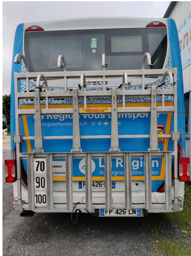
Système de rack à vélos vertical pour 8 vélos mis en place en 2011 Source : Galéo
