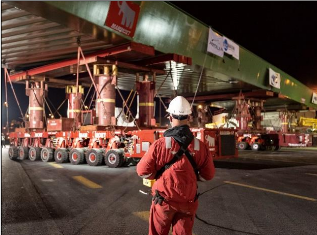
Photo 14 : Opérateur pilotant un chariot à l'aide d'un boîtier de commande raccordé au powerpack maître
