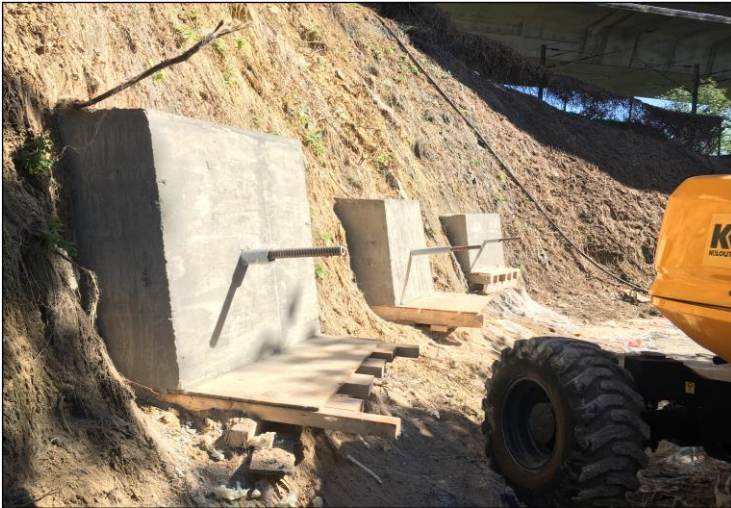
Figure 25 : Massifs réalisés sur le mur en Texsol pour les essais de traction sur les clous d'essai
