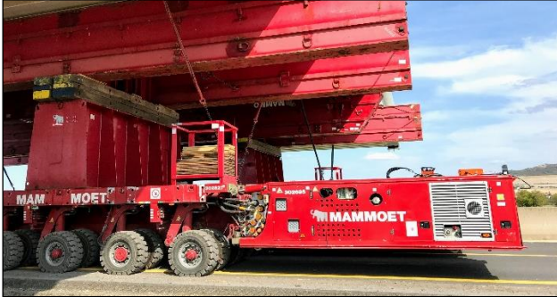
Photo 5 : Exemple de Powerpack constituant le système de motorisation et de levage des remorques – Vue de coté
