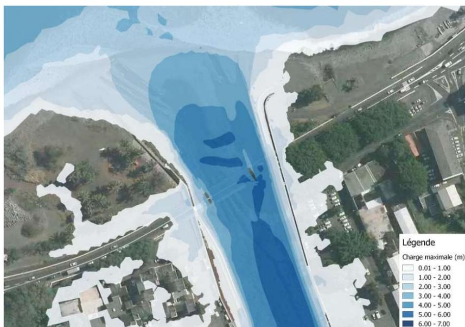
Figure 9 : Hauteurs de charges maximales – Etat initial pour la crue centennale sans embâcle sous le pont de la RN1
