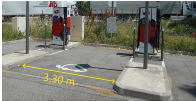
Exemple d'emplacement réservé à la recharge de véhicules électriques accessible aux personnes titulaires de la carte mobilité inclusion, mention « stationnement » tant pour la place que pour la borne elle-même. La peinture de l'emplacement n'est pas souhaitée.
